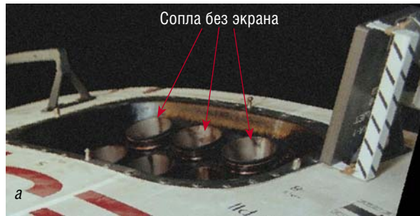
В космическом эксперименте «Кромка-1» исследовали влияние защитного экрана на распространение «грязи» (веществ, образующихся при сгорании топлива) вдоль поверхности корпуса МКС: а – до установки экранов; б – после установки экранов на сопла двигателей системы ориентации
