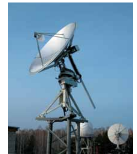
Приемная станция «СПОИ» предназначена для устойчивого приема данных дистанционного зондирования Земли (диаметр зеркала – 3,6 м, диапазон 8,2 ГГц)
