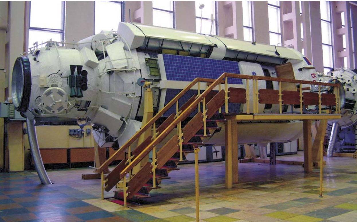
Тренажеры ЦПК им. Ю. А. Гагарина представляют собой полномасштабные натурные макеты орбитальных станций, служебных модулей и транспортных космических кораблей. На фото – тренажерный зал российских модулей «Заря» и «Звезда», входящих в состав Международной космической станции
